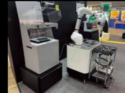
Carbon 3D printerで自動化によるワークへのパーツ挿入を初実現
