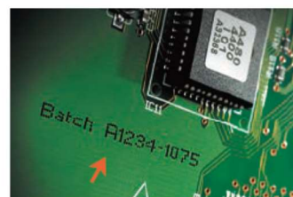
基板へのマーキング (耐アルコールインク)
