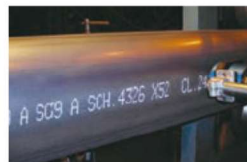
鋼管へのマーキング
