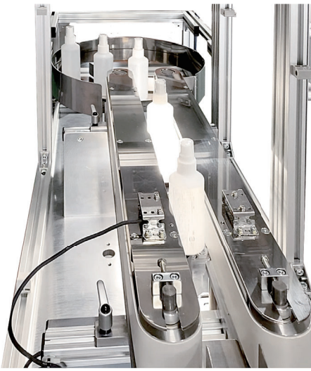
ボトル底面印字検査装置 (連続式インクジェットプリンター CCS3500+ 印字検査装置 PK100) NEW
