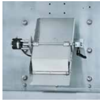
シャッター装置
