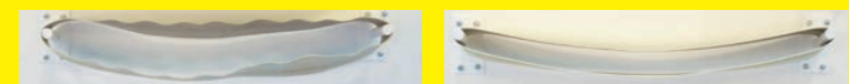
従来ベルト すり込み収縮でベルト変形 低収縮ベルト 収縮変形なし
