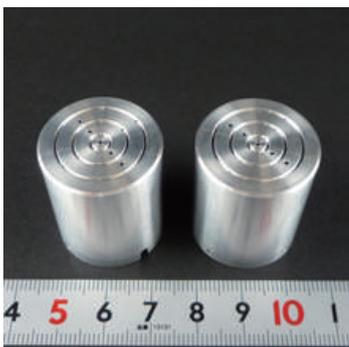
加工 旋盤加工／細穴放電加工
