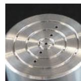
半導体製造装置部品に用いられる為、傷や打痕不可で、バリやカエリにより製品搬送に影響の出ない様、注意し加工しています。又、真円度、同芯度などの加工精度要求がなされています。部品上面に幅 0.7mm 深さ 0.5mm の溝が加工され、穴径 0.5mm と 0.3mm の細穴が施されています。弊社では、0.05（50μ）程度の微細加工が可能です。
