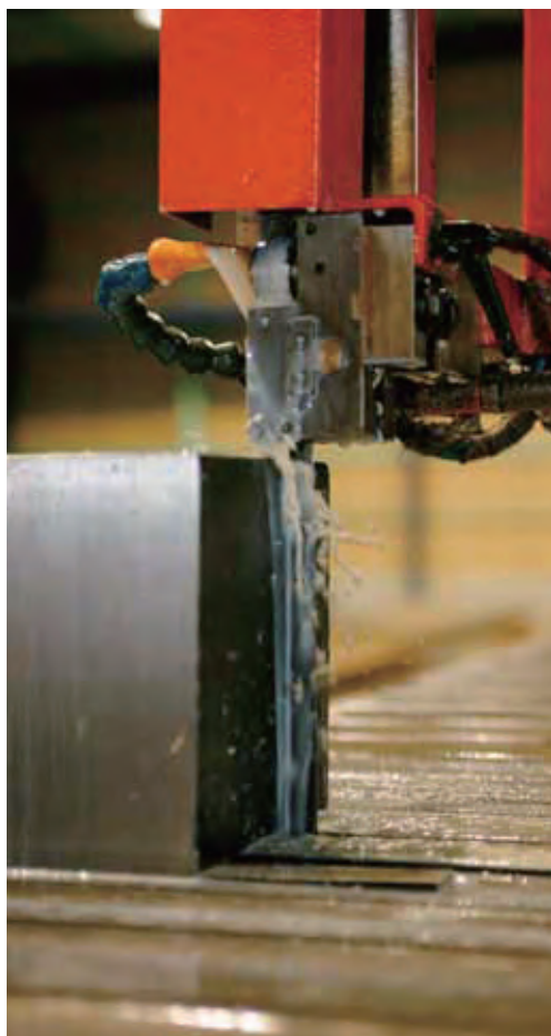
厚物鋼材の切断
