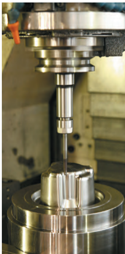
長い突出しでも、底面のコーナー Rまで正確に仕上げ加工
