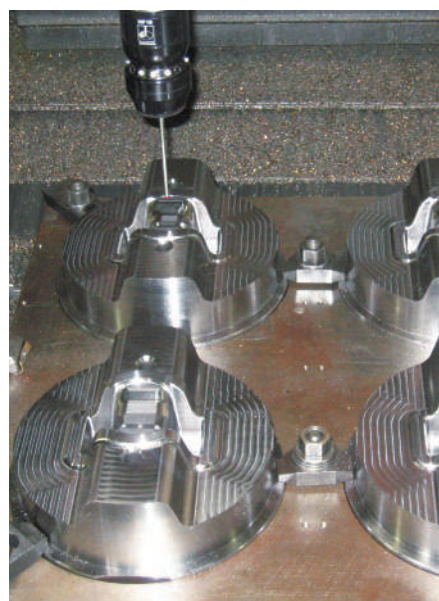
加工機上での自動寸法測定
