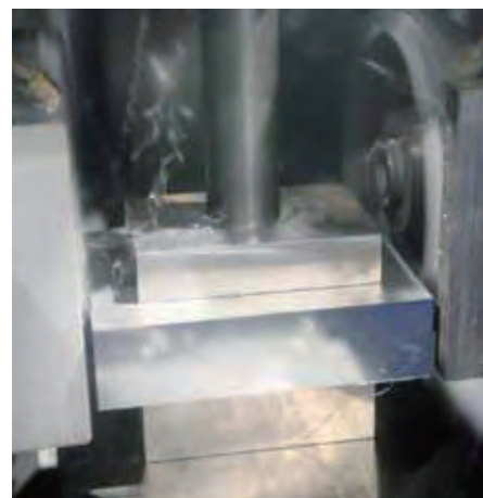
アルミプレートの側面フライス加工
