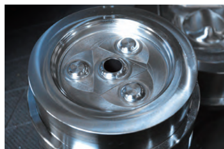
高剛性と高精度の一致で作り上げた鍛造用金型
