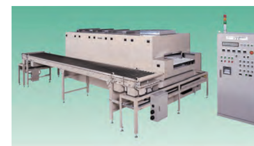
ローラース式焼成炉 (工学レンズガラス粉末用)
