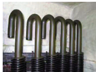
実物フィンチューブの加工状況
