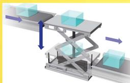
昇降速度 9.5/14.2 (ストローク1m/ストローク1.6m) m/min
