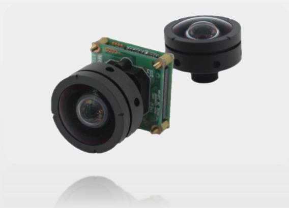
弊社独自の光学設計技術により、歪みを最小限に抑えることに成功した画期的で新しいレンズです。水平画角120°という超広角レンズでありながら、ディストーションを2%以下に抑えることで、**画像処理による歪み補正を必要としません。** ※歪以外の画像補正は必要となります。
