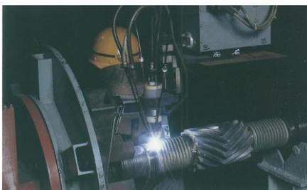
プラズマ粉体肉盛溶接は、低希釈の肉盛が可能でステライトや複合材料など、システムの特性を生かした耐摩耗、耐熱、耐食が要求されるバルブ、ポンプなどの部品に適用されます。
