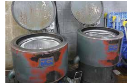
▲研磨機に併設されている脱水乾燥機。同社の研磨加工を支える
