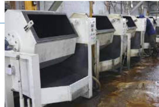
▲東洋バレル技研は6台の研磨機で研磨加工を行う
