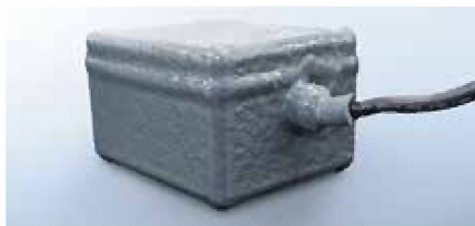
↑ ecomo内部はアクリル樹脂製の塗料で保護されています。
