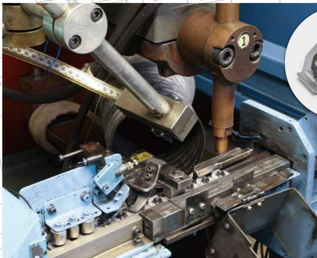
スポット溶接ライン
