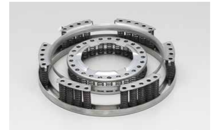
■クラッチリターン Springs 組立 自動変速機内で使用され、コイルばねをプレート2枚で固定する構造により、ねじれ剛性向上と自動組み立てを可能にしました。
