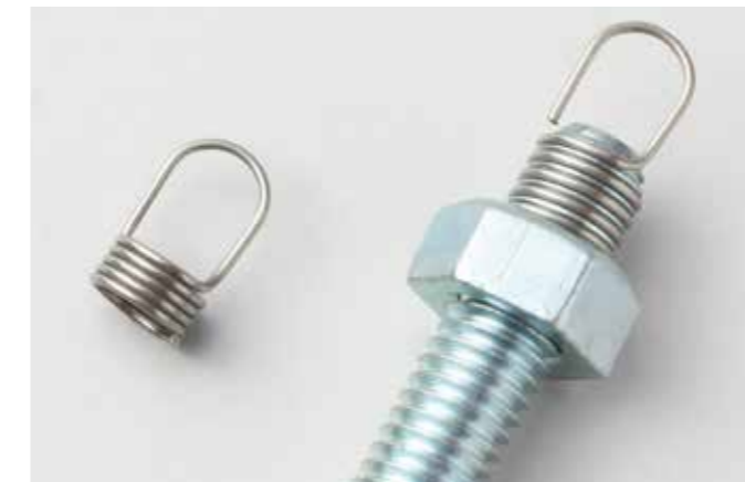
■脱落防止具 ばねがボルトねじ谷部に入り込み塞ぐ事で振動によるナットの脱落を防ぎ、安全性の向上や作業性の省力化を可能にしました。
