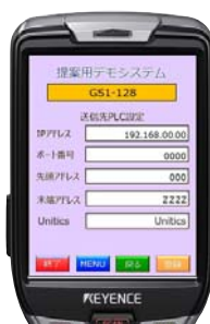
送信先PLC設定画面
