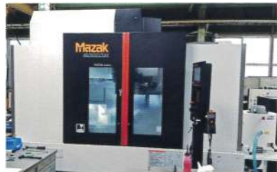
マシニングセンター MAZAK VCN-530C 加工能力: x1050×Y530×Z510
