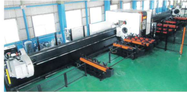
形鋼専用 三次元レーザー加工機
