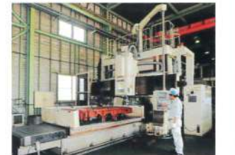
門型CNCマシニングセンター 門幅 2,000 X4,000 Y1,500 H700
