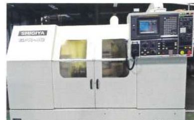
CNC円筒研削盤 シギヤ精機 GPX-40 加工能力: 最大加工径φ300、センター間距離250
