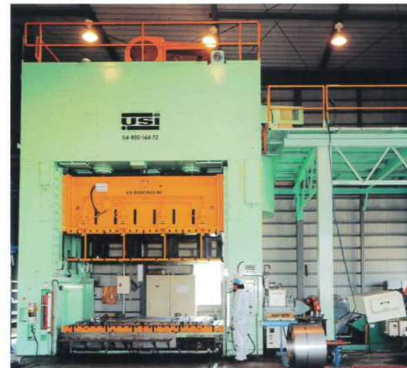
800tTRF&プログレダイショック付プレス ベットサイズ X3,800 Y1,800 H714~966 アンコイラー コイル幅 1,300まで 板厚 0.5~3.2tまで
