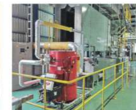
リン酸処理装置 メーカー:ケミコート 型式:節水クローズド式
