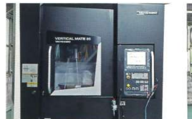
立形複合研削盤 TAIYO KOKI VERTICAL MATE 85 加工能力: φ800
