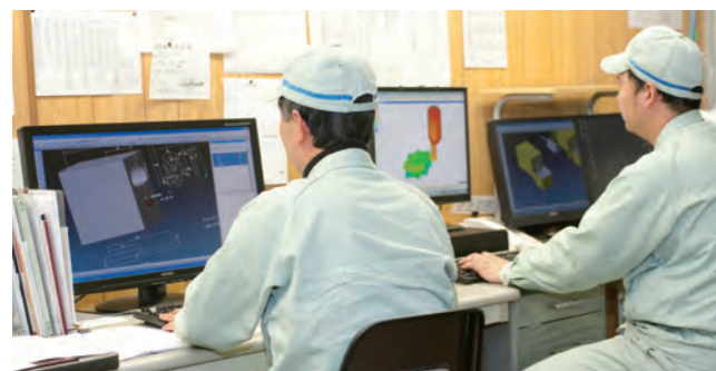
◀3次元CAD/CAMシステムによるモデリングからCAD/CAMシステムを用いたNC加工まで一貫した製作を行うことで、合理化、納期の短縮を図っています。
