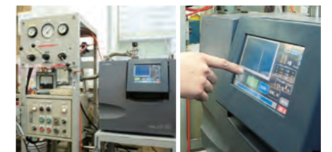
▲当社の鑄物部品が通常行うリークテストにおけるリークレート。(当社のリークディテクターの最大検出レートは 1.0 \times 10^{-13} \text{Pa} \cdot \text{m}^3/\text{sec} 。)
