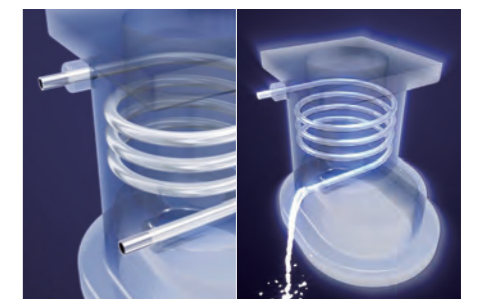
▲パイプ鑄込み：アルミ合金鑄物にステンレスパイプなどを高い気密性を保ったまま鑄込みます。
